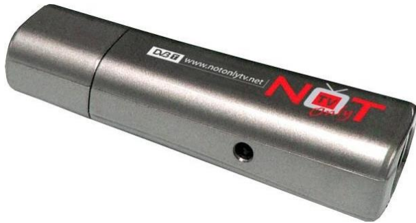
Obrázok 2. Rádiový prijímač RTL-SDR.
