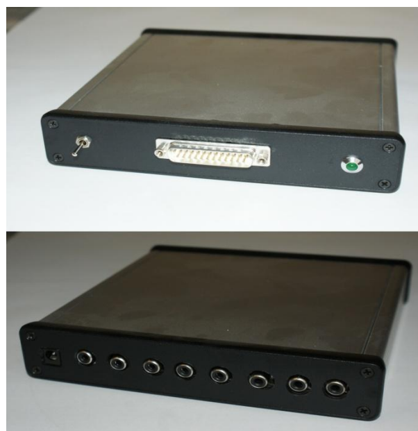
Obr. 5 Osemkanálový A/D prevodník.
