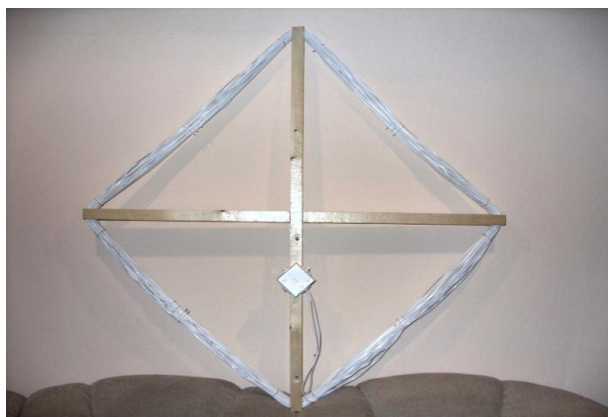
Obr. 6 Rámová anténa pre príjem VLF signálu
